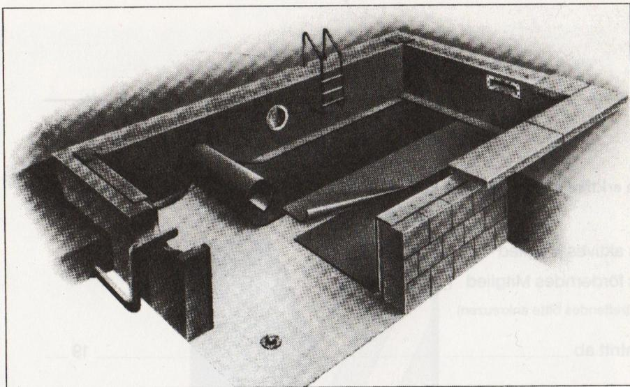
Abb.: Auskleiden und Dichtmachen eines Schwimmbades
